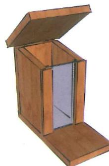
6. Monter le toit avec une charnière à l'arrière.
