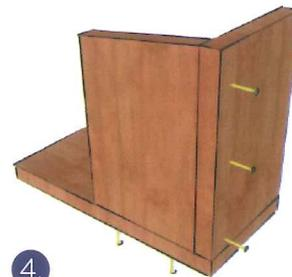
3. Fixer un côté (trois vis à l'arrière et deux dessous).
