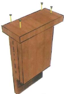
4. Fixer le toit. Il doit dépasser à l'avant et sur les côtés.
